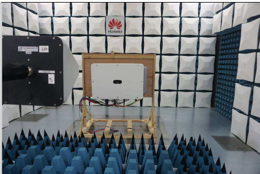
EFT TEST (AC Power Port)
