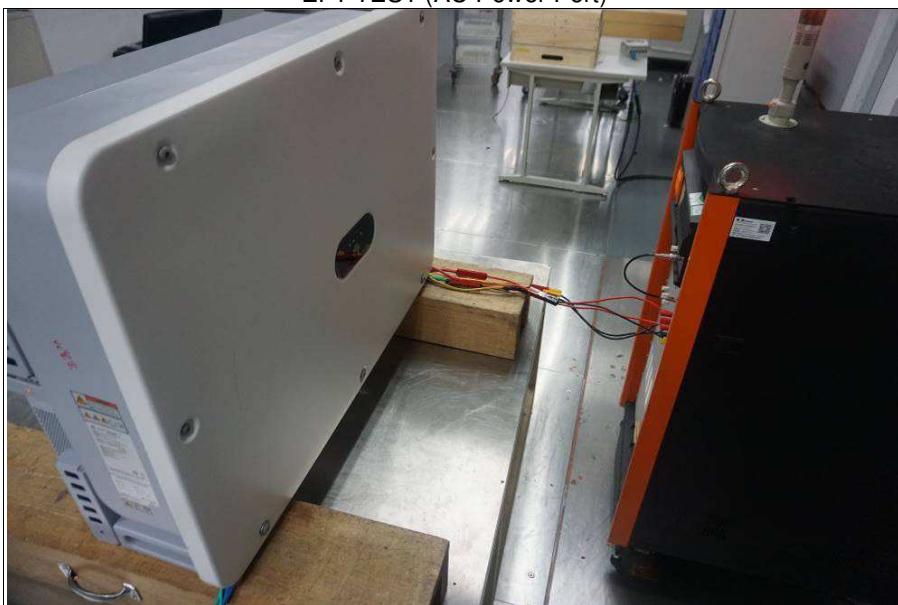
EFT TEST (AC Power Port)
